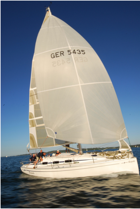
Beispiel Bavaria 35 Match GI: 42,10m 2 Code-0: 58,95m 2 Unterliek Code-0: 6,90m MWmin: 5,20m
